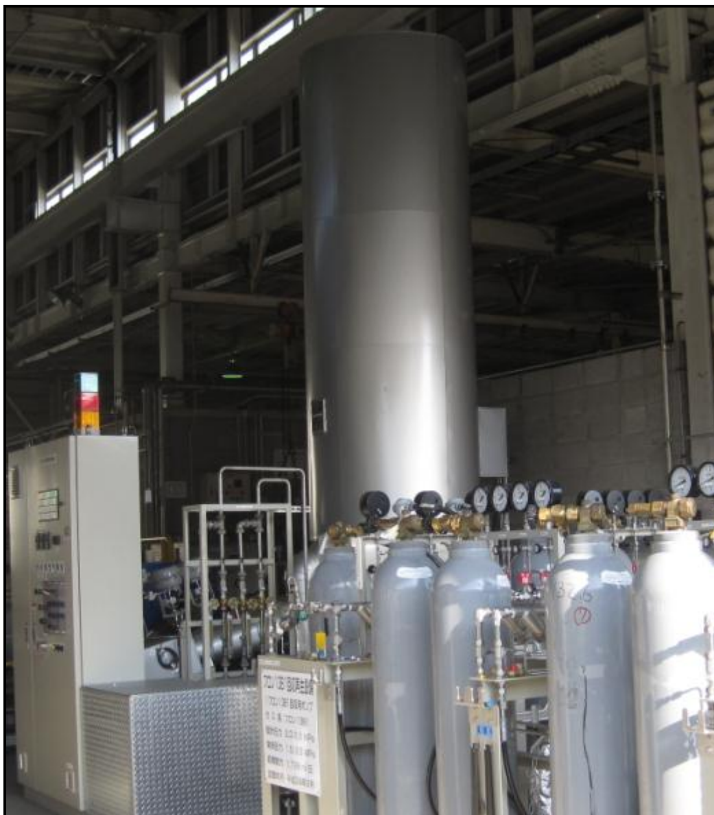
▲関西総合ガスセンター リプレース後のハロン回収装置
